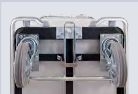
Фиксатор направления для тележек с внутренней длиной до 1000 мм. Фиксация направления происходит при отжатой педали.
